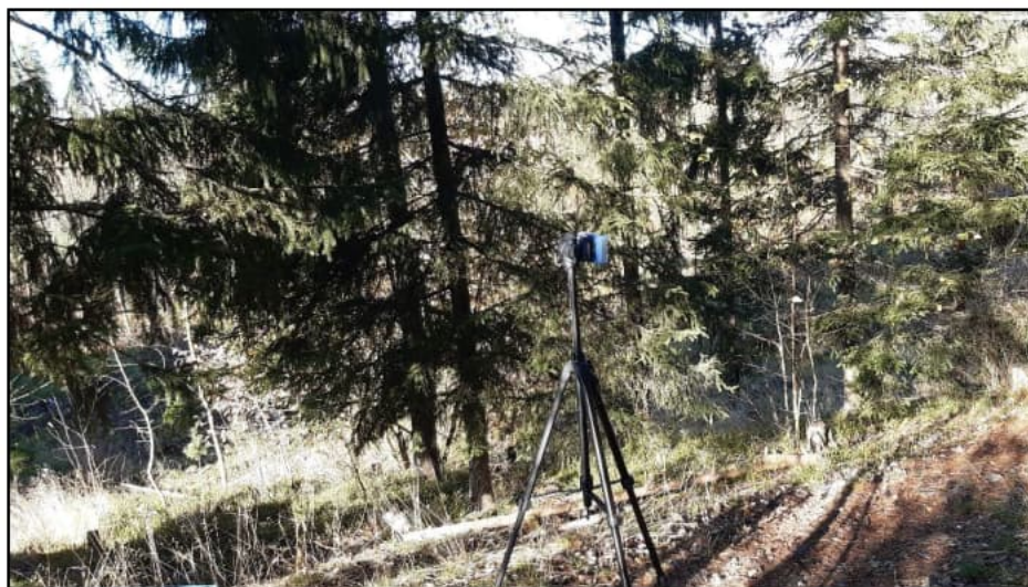
Kuva 3. Mittaustapahtuma ja äänitasomittarin sijainti mittauspisteessä MP2.
