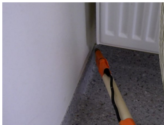
Kuva 43, Tyypillinen ilmapuotokohta nurkassa
