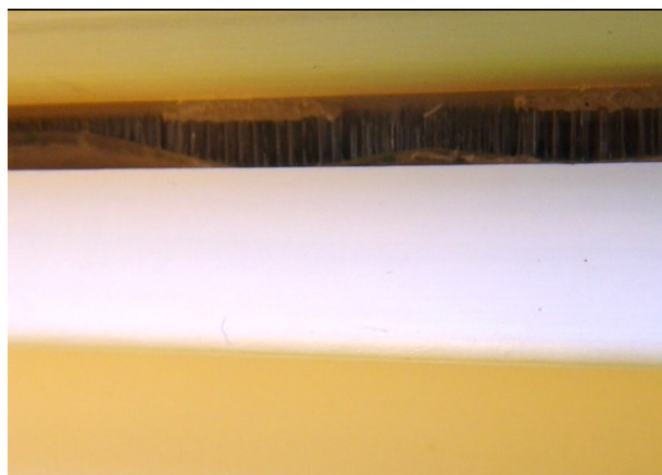
Kuva 15, Tiivistysteipin liimapinta venyy tasaisesti
