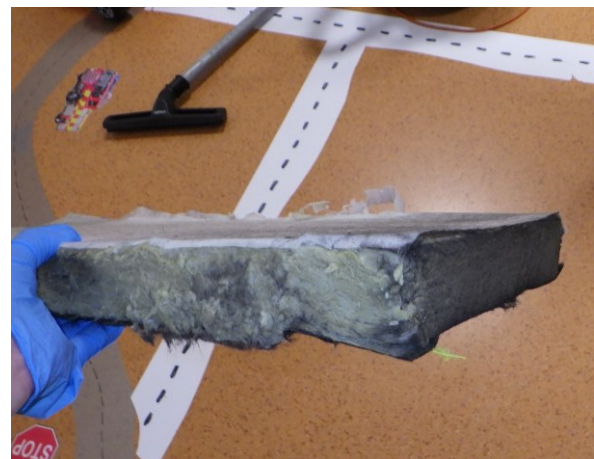
Kuva 30, Kanavassa ollut villalevy oli tummunut
