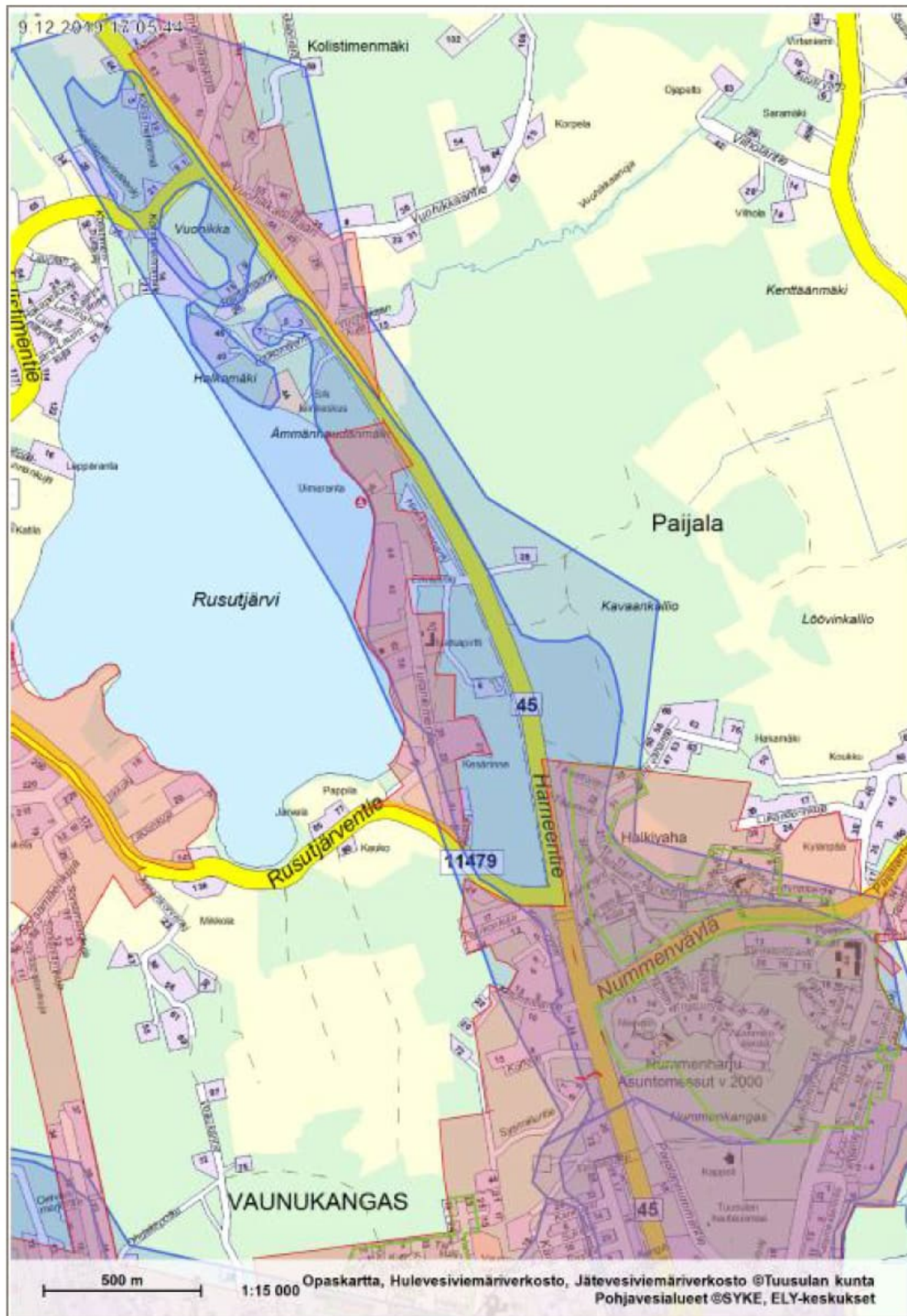
Kuva 24. Vesihuollon toiminta-alueen nykyinen raja Rusutjärven pohjavesialueen kohdalla. Pohjavesialueen rajat on merkitty sinisellä viivalla; punaisella rasterilla on merkitty jätevesiviemäriverkosto ja vihreällä viivalla hulevesiviemäriverkosto (lähde: Tuusulan kunnan karttapalvelu).
