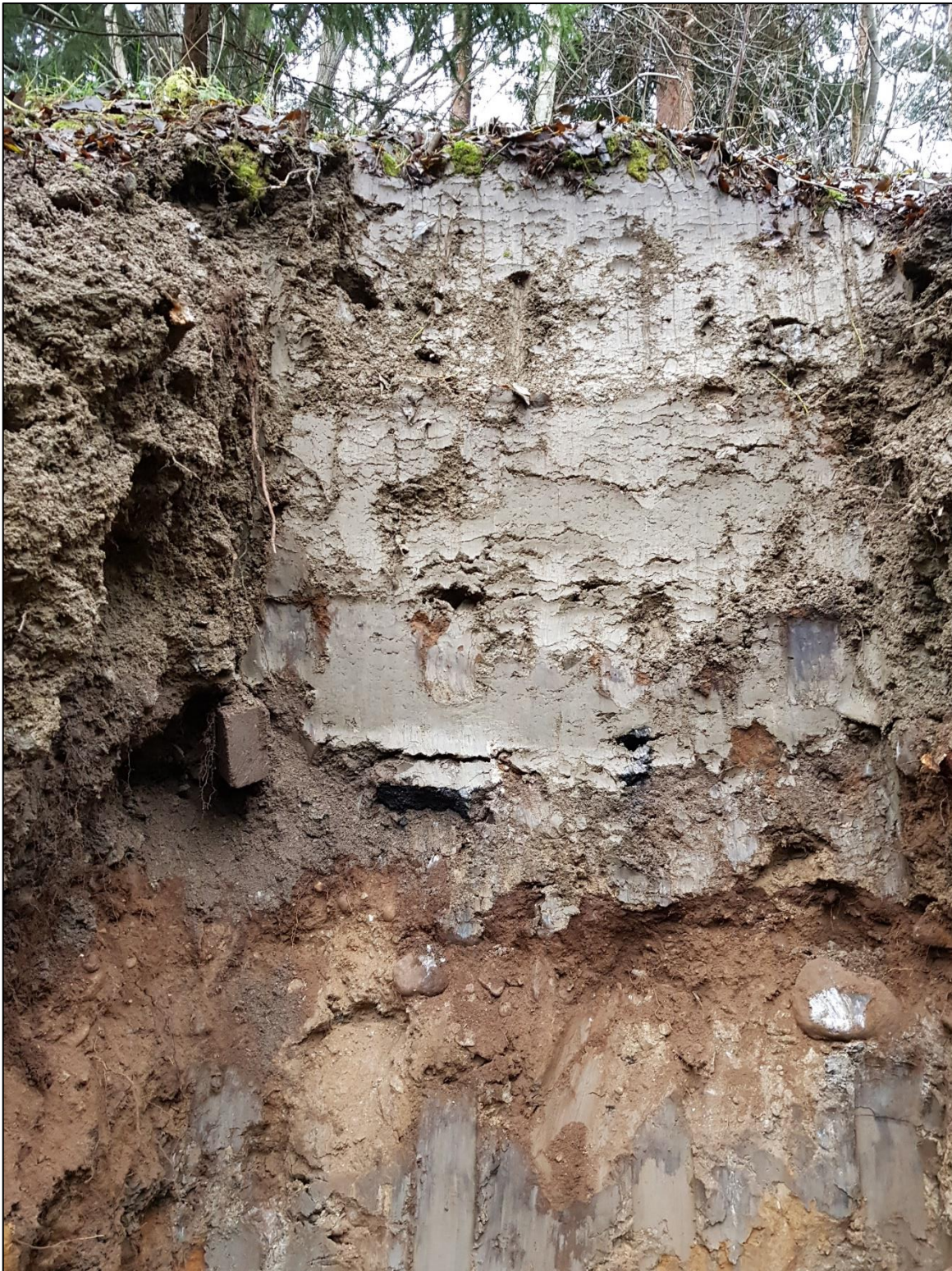
Kuva 5. Useassa tutkimuspisteessä havaittiin pieniä määriä jätėjakeita, pääasiassa tiiltä tai betonia. Koekuoppa SE22.
