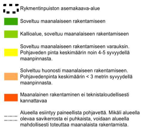
Kuva 7. Maanalaiseen rakentamiseen soveltuvat alueet, pohjaveden pinnan etäisyys maanpinnasta
