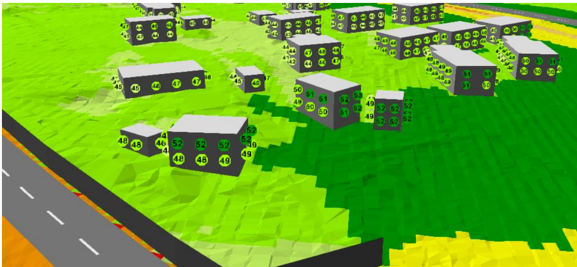
Kuva 4. Julkisivuihin kohdistuvat korkeimmat yöaikaiset keskiäänitasot ennustetilanteessa 2040.
